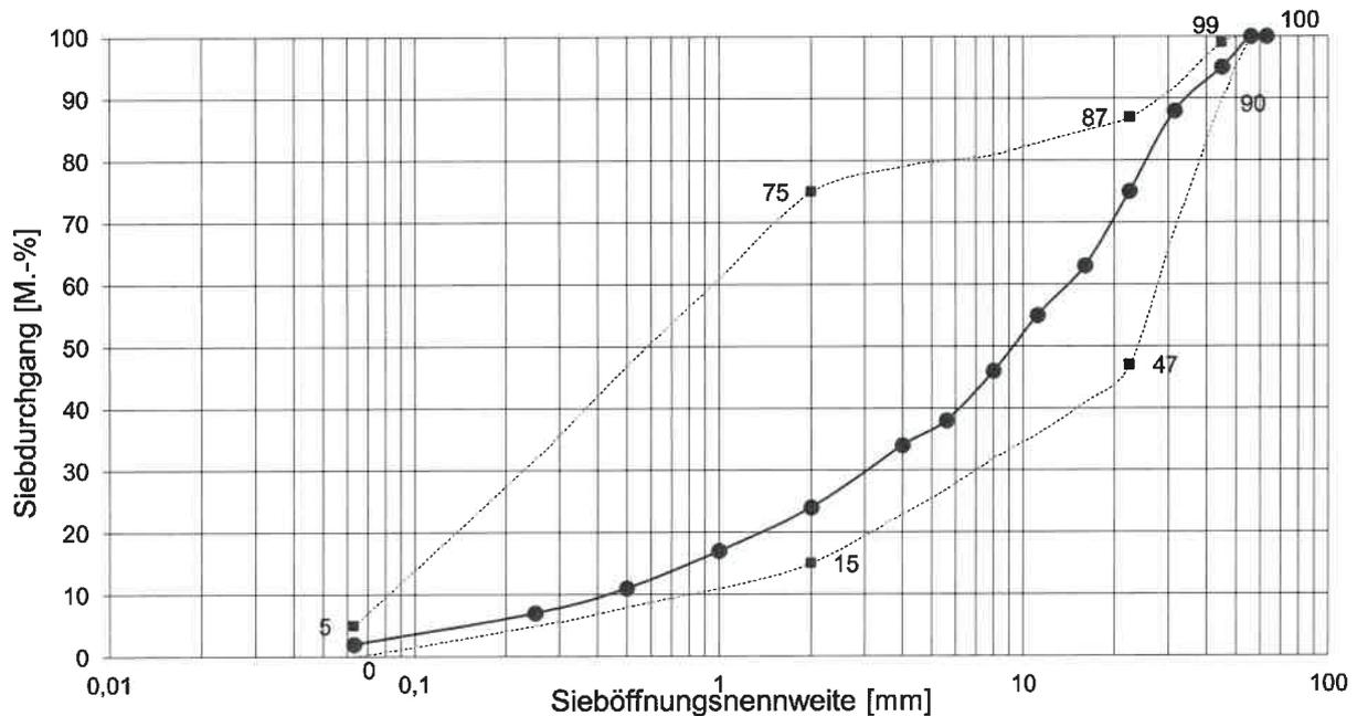
Abbildung 2: Korngrößenverteilung der Frostschuttschicht 0/45 UF<sub>3</sub> im Sieblinienbereich der TL SoB-StB 20
