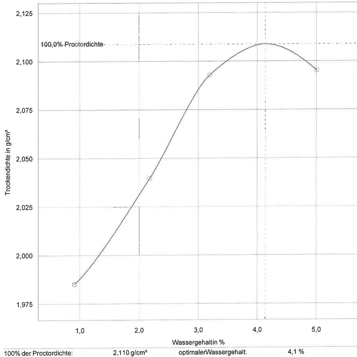
Abbildung 2: Frostschuttschicht 0/45 UF3 - Proctorkurve
