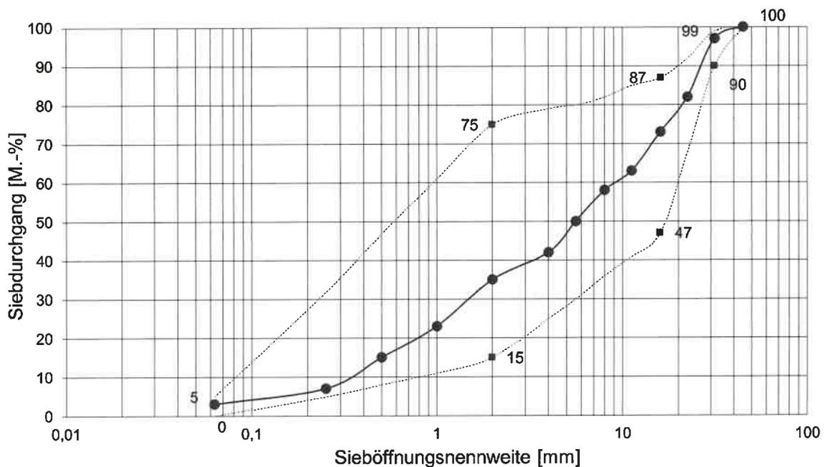
**Abbildung 1:** Korngrößenverteilung der Frostschuttschicht 0/32 UF<sub>3</sub> im Sieblinienbereich der TL SoB-StB 20
